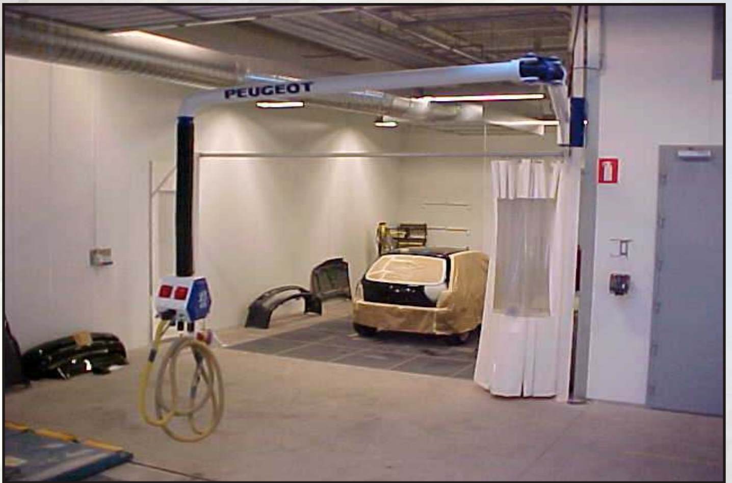
MFB 520 monteret på 6 meter svingarm
