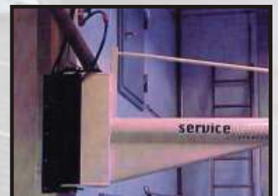
Drejeled med bøsninger og justerbare anlægsskiver.
